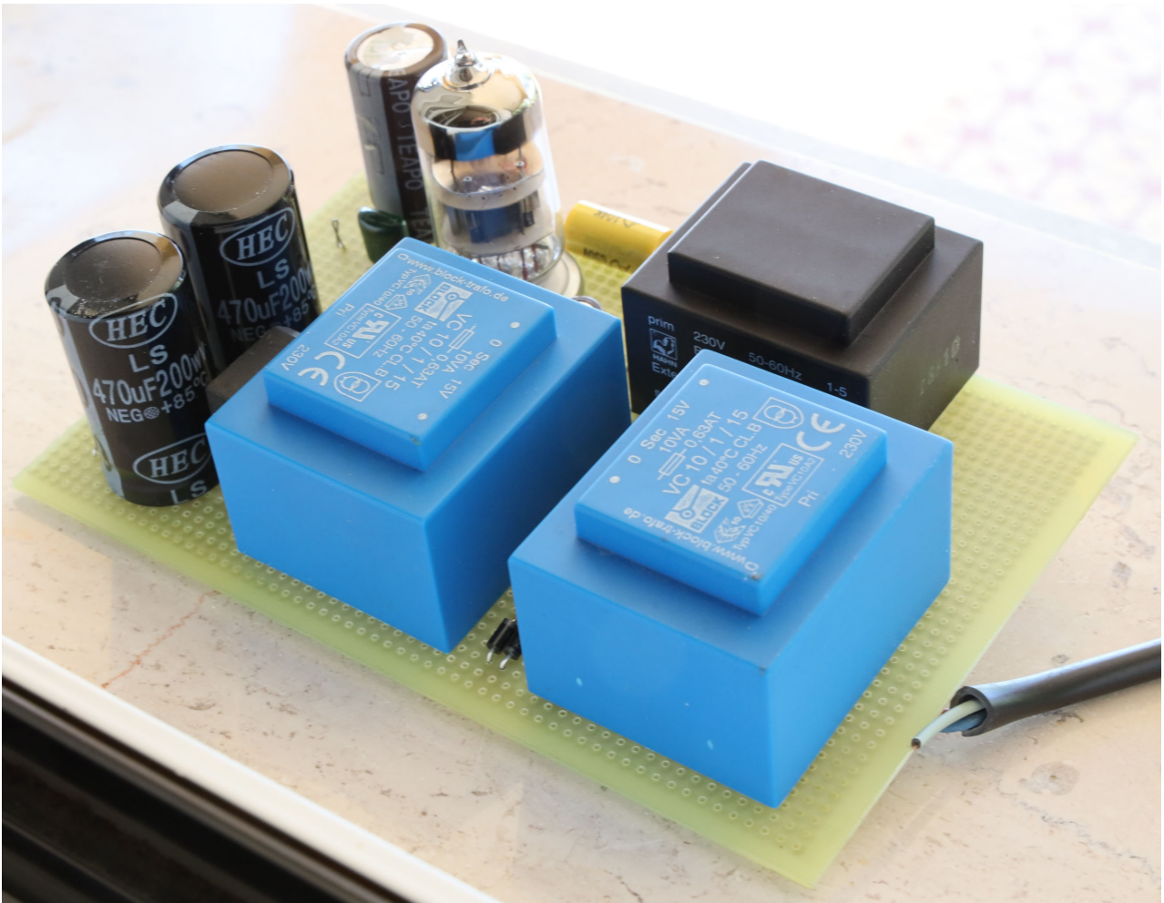
Prototipo montato su basetta millefori visto dal fianco.
