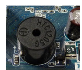
Esempio di altoparlante inserito sulla scheda madre di un pc.
