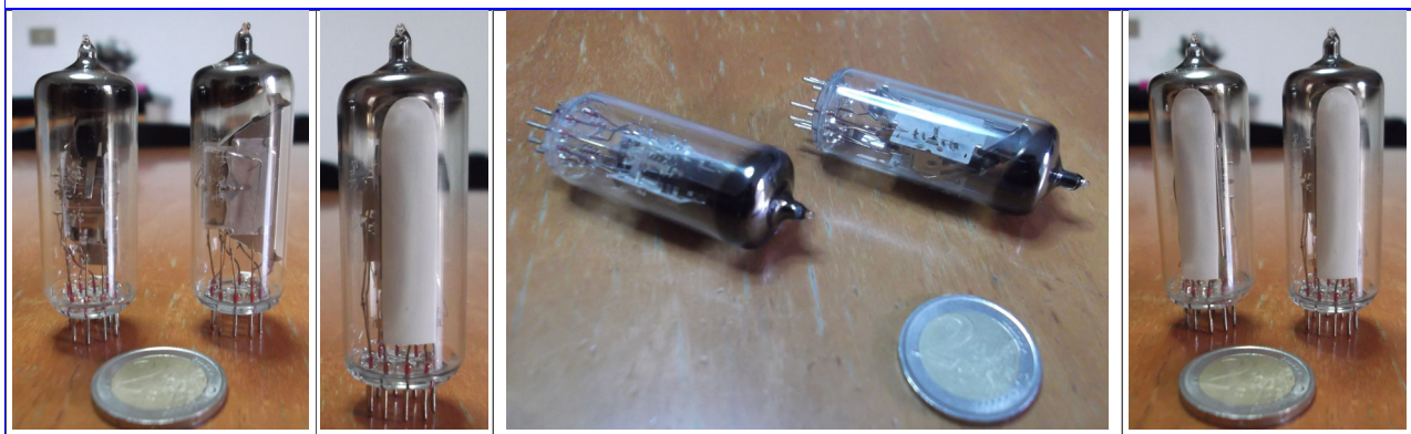
Sopra un classico esempio, un occhio magico a ventaglio fra i più usati un EM81 Philips. Emette una luce verde.
