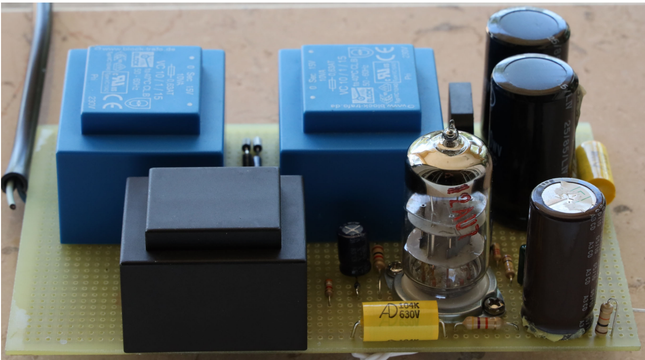
Prototipo montato su basetta millefori visto dal fianco.
