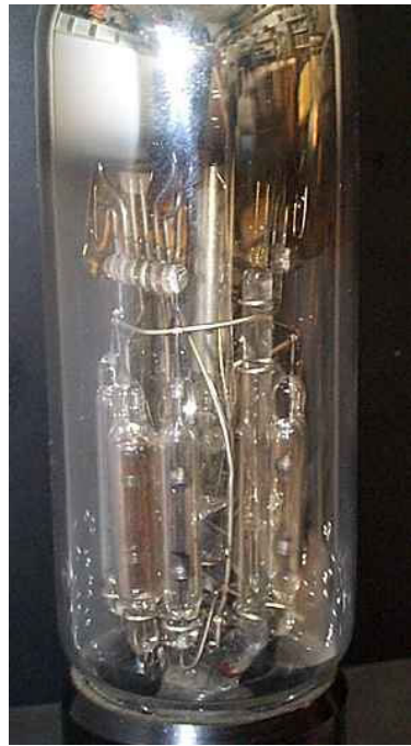
Sopra una foto ravvicinata di una valvola 3NF che mette in evidenza la complessità interna.
