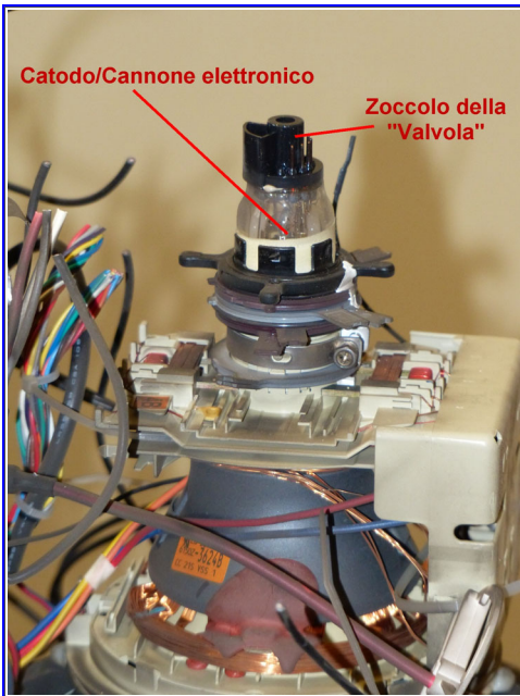
Particolare del catodo (cannone elettronico) del tubo a raggi catodici.
